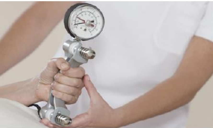
Dinamômetro de compressão usado em tratamentos de fisioterapia, para medir a quantidade de força do indivíduo.
